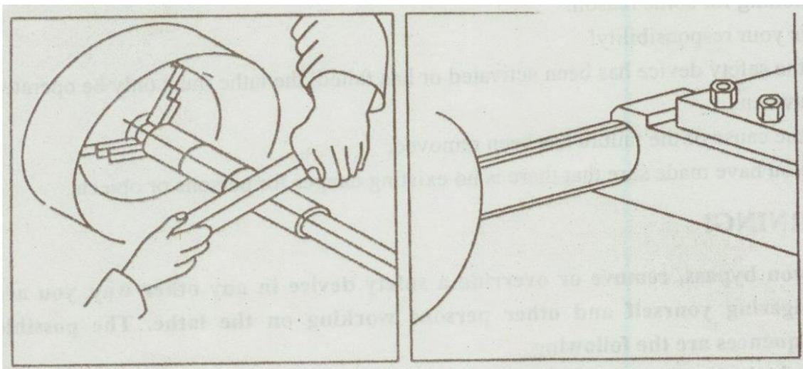
б. Наждачная бумага зафиксирована и зажата в державке для шлифования.
